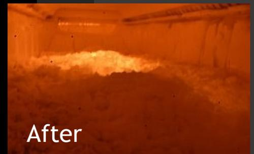
Fuse Tech tiene la capacidad de cortar paredes refractarias y coronas mientras la unidad de producción está en funcionamiento.
